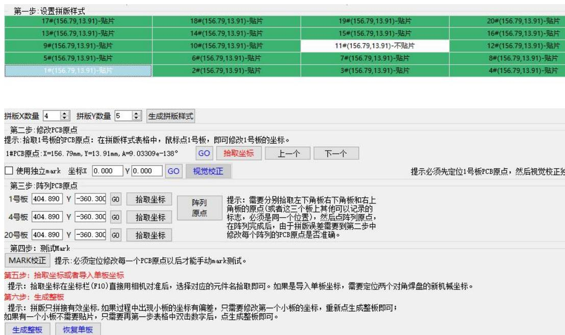
1、参考 5.2.3 机械 MARK 定位方法，要求稳定视觉识别 MARK12。如果是拼板可以使用工艺边 MARK，或者使用对角两个小板上的 MARK 点，距离越远精度越高。（必须是第一步）
