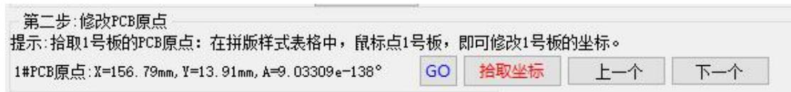
4、在【拼板】第二步中，默认不勾选【使用独立 MARK】，可以提高 MARK 识别速度。独立 MARK 的功能要求每个小板上必须有 1 个 MARK 点，在贴片过程中，视觉识别完对角 MARK 以后，会继续识别每一个小板上的独立 MARK 点，可以提高单板的精密配件贴片精度，如果识别不到小板上的独立 MARK 点，则可以自动跳过当前小板不做贴片，所以可以通过用黑色笔涂抹独立 MARK 点让设备自动避开作废的小板。如果使用独立 MARK 点，则需要点【GO】，然后与 5.3 中完全相同的视觉调整方式，然后视觉稳定识别独立 MARK 点，并点【视觉校正】，完成独立 MARK 点的调试。
